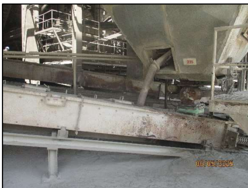
รูปที่ 2-41 การลำเลียงฝุ่นจาก SP Boiler โดย Drag Chain ในระบบปิด
