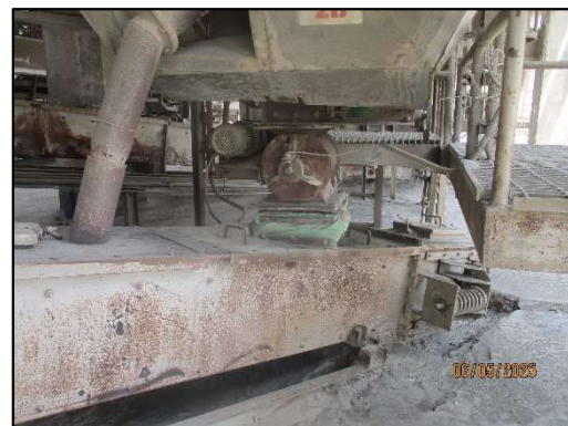
รูปที่ 2-42 การดักจับฝุ่น ชนิด Dust Settling Chamber
