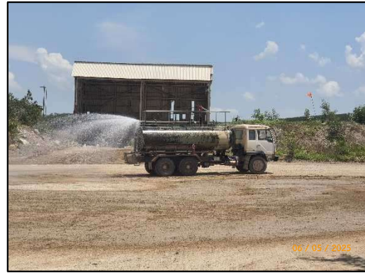
รูปที่ 2-14 การฉีดพรมน้ำบนถนนที่ใช้ขนส่งแร่
