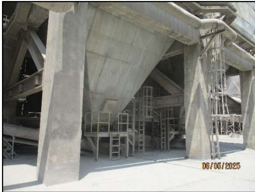
รูปที่ 2-43 การลำเลียงฝุ่นจาก AQC Boiler โดย Drag Chain ในระบบปิด
