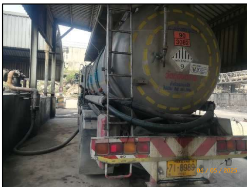
รูปที่ 2-29 การถ่ายของเสียประเภทของเหลวด้วยท่อสำหรับขนถ่ายของเสีย
